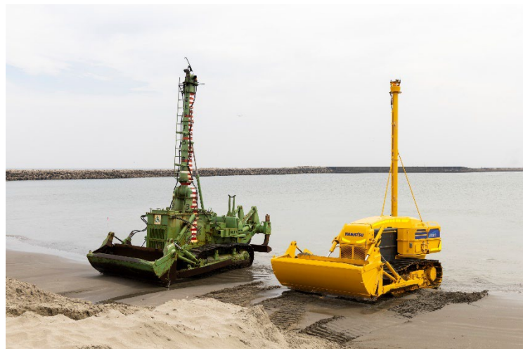
左：水陸両用ブルドーザー 右：水中施工ロボット（コンセプトマシン）
